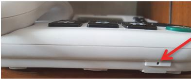
Das Mikrofon befindet sich auf der Vorderseite des Telefons. Damit der Angerufene die Nachricht laut und deutlich hört, ist es nötig dass Sie aus geringem Abstand laut in das Mikrofon sprechen.
